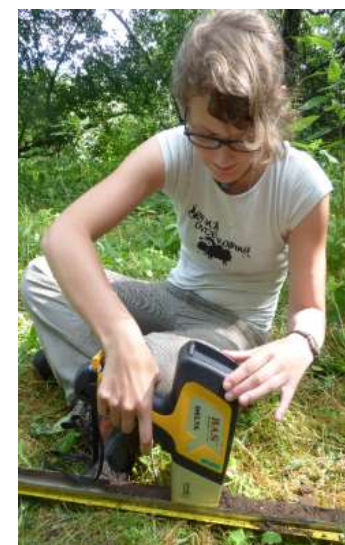
měření vybraných prvků v půdě pomocí přenosného XRF spektrometru DELTA Premium
