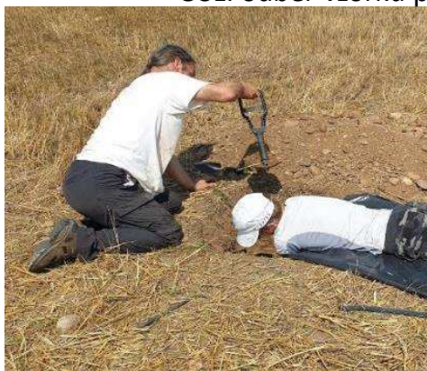
OSL: odběr vzorků písku bez přístupu světla pro datování stáří
