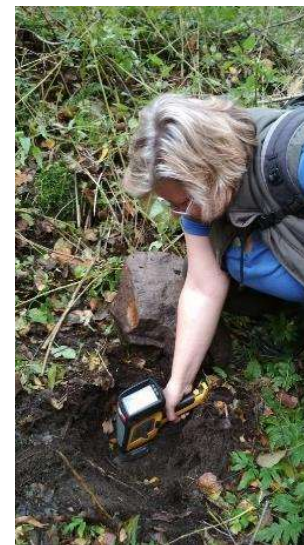
měření vybraných prvků v půdě pomocí přenosného XRF spektrometru DELTA Premium
