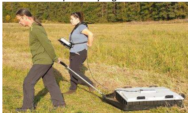
měření přenosným georadarem
